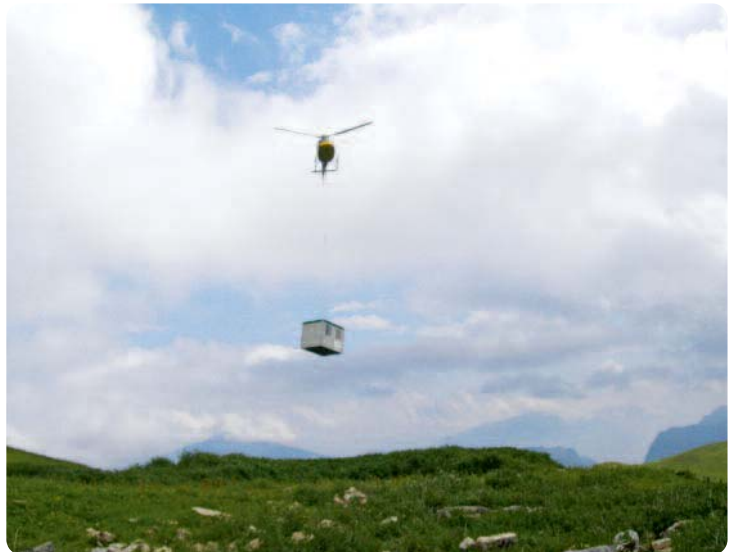
Foto n. 11 - Trasporto in quota di un modulo abitativo (Archivio Servizio Foreste e fauna PAT)
