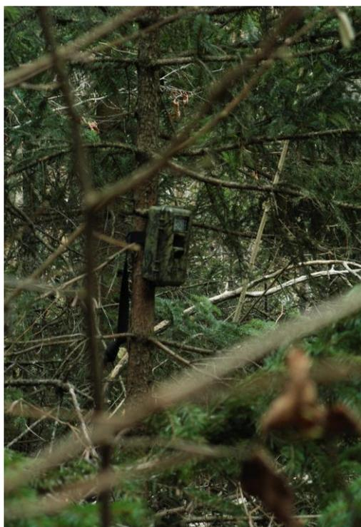
**Figura 18** Il montaggio della fototrappola richiede particolare attenzione: il punto d’installazione deve massimizzare l’area di sorveglianza ed al contempo essere sufficientemente mimetica per arrecare il minor disturbo possibile.
